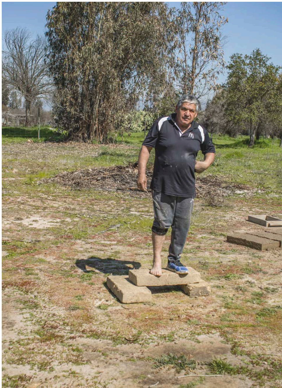
CF8 FABRICACIÓN DE ADOBES Maestro Gabriel Núñez realizando prueba de resistencia de un bloque seco.
