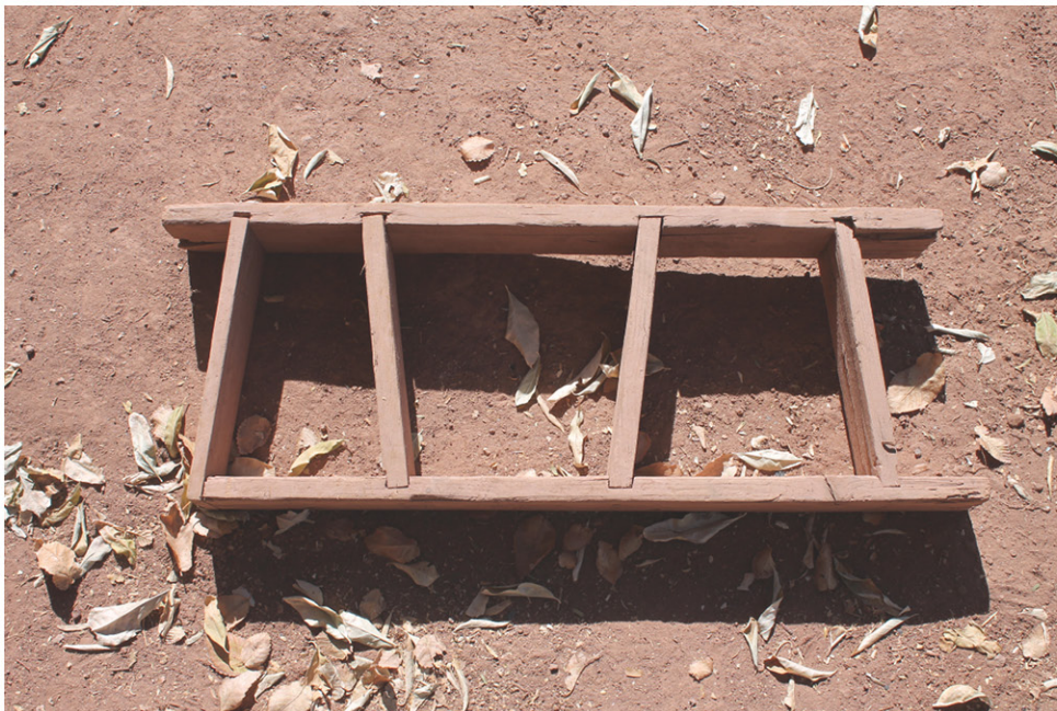
CYR037 HORNO Adobera trapezoidal para la construcción de piezas para hornos. (Véase testimonio de Juan Siares Flores)
