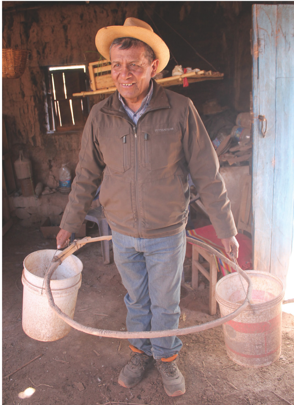
C1F10 DETALLE Roberto García usando herramienta utilizada para transportar agua desde el río. La forma circular de este artefacto impedía que los pesados baldes golpearan las piernas al caminar.
